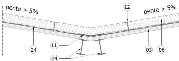
Une bande métallique (11) est placée et fixée au-dessus de l'élément porteur, sous le pare-vapeur, la mise en œuvre de cette bande métallique (quelle que soit la largeur du joint du joint des éléments à base de bois au faîte ou en noue) est obligatoire sur deux appuis.
