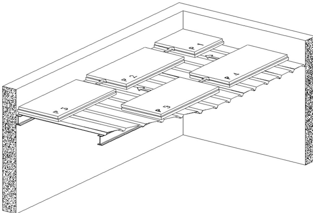
**Figure 2 – Schéma de pose du premier lit en panneaux Fesco C-DO**
