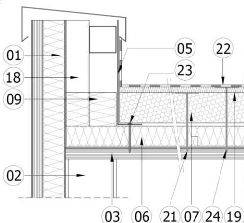
Figure 13c – Exemple de costière métallique placée sur le premier lit Fesco C-DO et 3<sup>ème</sup> lit Fesco C ou Fesco C-S
