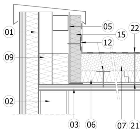
Figure 14 – Exemple de costière métallique isolée contre des poteaux
