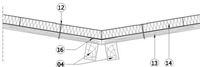
Figure 18c – Raccordement des panneaux Fesco C en noue - Appuis doubles
