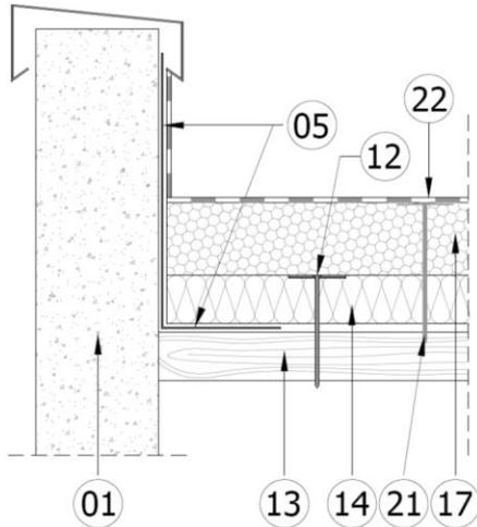
**Figure 23 – Exemple de costière métallique contre un mur**
