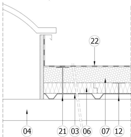
**Figure 8 – Exemple de raccordement sur lanterneau ou exutoire de fumée pré-isolé en panneau de perlite expansée (fibrée) ou laine de roche (résistance thermique déclarée minimale conforme à sa norme produit)**
