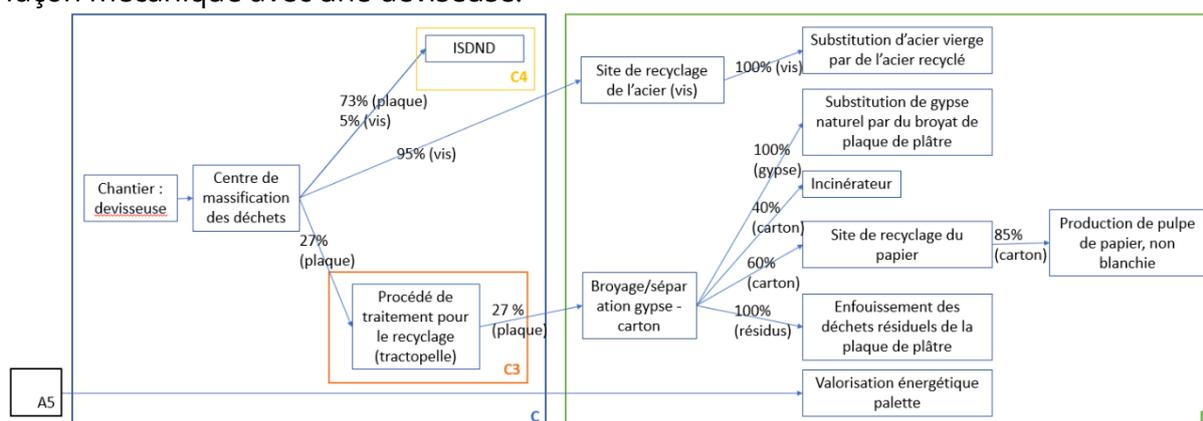
Schéma des modules C et D<sup>3,4,5,6</sup>
