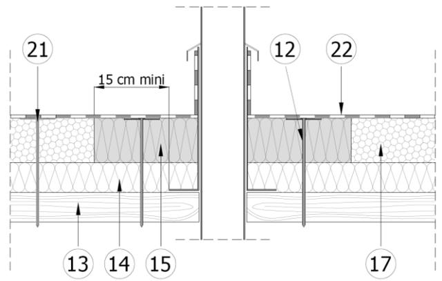
Le calfeutrement autour du fourreau de conduit ou gaine métallique traversant la toiture est réalisé par un panneau laine de roche (15) d'épaisseur égale à celle du lit supérieur en panneau KNAUF Therm TTI Se (17) et découpé sur une largeur dépassant de 15 cm au moins le bord de la platine ; il est placé au-dessus de l'écran thermique (14) et est fixé mécaniquement (12) dans l'élément porteur (13).
