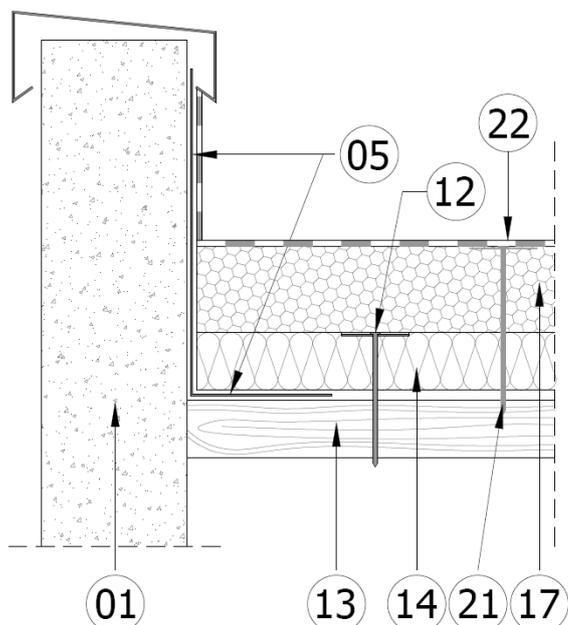
L'aile horizontale de la costière métallique (05) est fixée dans l'élément porteur selon le NF DTU 43.4 P1.
