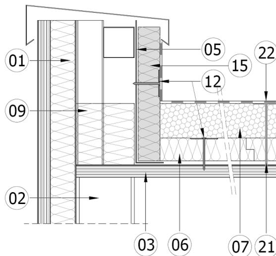
L'espace situé entre la costière métallique et la paroi verticale est comblé par un isolant (09) de classe A2,s2-d0 au moins, d'épaisseur minimale 60 mm.
