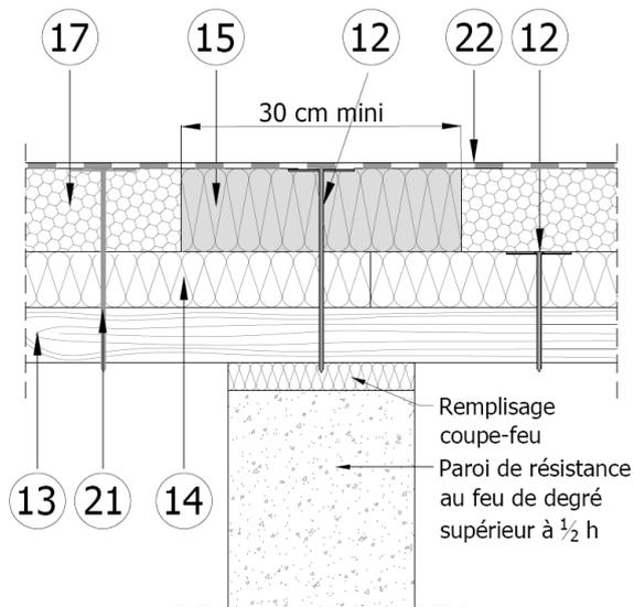
Le recouplement est réalisé par un panneau laine de roche (15) d'épaisseur égale à celle du lit supérieur en panneau KNAUF Therm TTI Se (17) et découpé sur une largeur minimale de 30 cm ; il est fixé mécaniquement dans l'élément porteur (13) à raison d'une fixation (12) par panneau.
