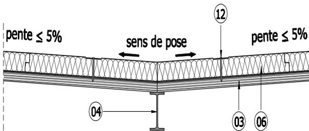
Le joint filant entre les panneaux DDP RT LJ (06) est situé au droit d'un élément d'ossature principal ou secondaire (04).
