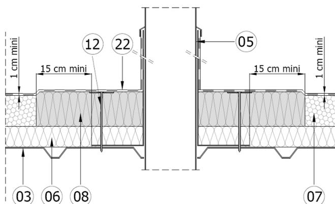
Le calfeutrement autour d'un conduit ou gaine métallique traversant la toiture est réalisé par un panneau de laine de roche (08) d'épaisseur supérieure d'au moins 1 cm à celle du lit supérieur en panneau KNAUF Therm TTI Se (07) et découpé sur une largeur dépassant de 15 cm au moins le bord de la costière métallique (05) ; il est placé au-dessus de l'écran thermique (06) et est fixé mécaniquement (12) dans l'élément porteur (03).
