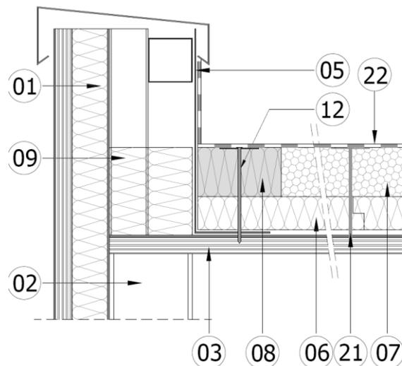
L'espace situé entre la costière métallique et la paroi verticale est comblé par un isolant (09) de classe A2, s2-d0 au moins, d'épaisseur minimale 60 mm.
