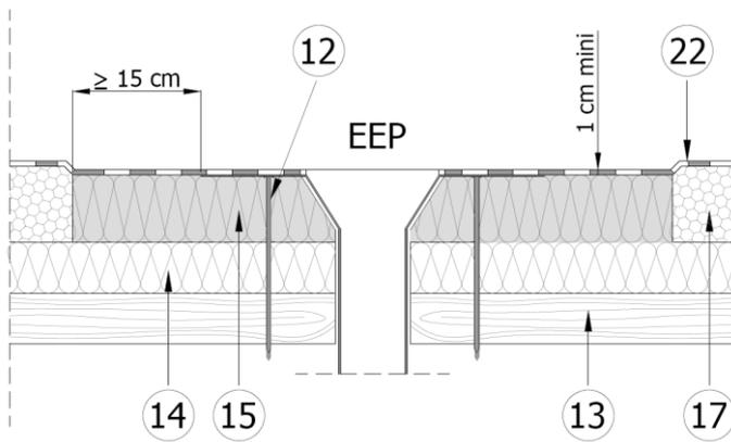
Le calfeutrement autour de l'évacuation d'eau pluviale est réalisé par un panneau laine de roche (15) d'épaisseur inférieure d'au moins 1 cm à celle du lit supérieur en panneau KNAUF Therm TTI Se (17) et découpé sur une largeur dépassant de 15 cm au moins le bord de la platine d'entrée d'eau pluviale ; il est placé au-dessus de l'écran thermique (14) et est fixé mécaniquement (12) dans l'élément porteur (13).
