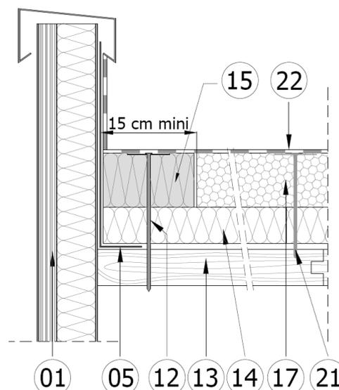
Le calfeutrement est réalisé par un panneau laine de roche (15), d'épaisseur égale à celle du lit supérieur en panneau KNAUF Therm TTI Se (17) et découpé sur une largeur minimale de 15 cm ; il est fixé mécaniquement à l'élément porteur (13) à raison d'une fixation (12) par panneau.
