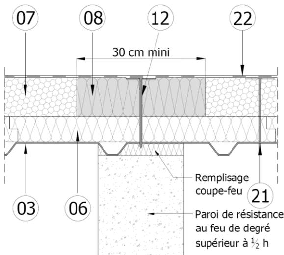
Le recouvrement est réalisé par un panneau de laine de roche (08) d'épaisseur égale à celle du lit supérieur en panneau KNAUF Therm TTI Se (07) et découpé sur une largeur minimale de 30 cm ; il est fixé mécaniquement dans l'élément porteur (03) à raison d'une fixation (12) par panneau.
