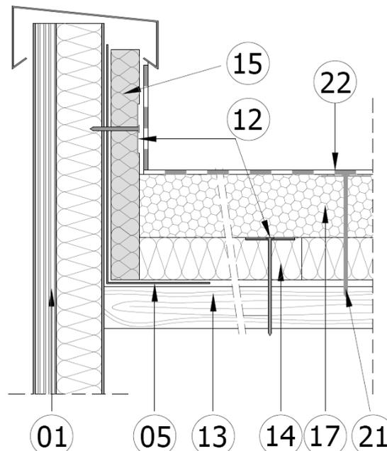
L'aile horizontale de la costière métallique (05) est fixée dans l'élément porteur selon le NF DTU 43.4 P1.
