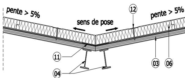
La mise en œuvre d'une tôle de liaison (10 - 11), quelque soit la largeur du joint des éléments porteurs au faite ou en noue, est obligatoire sur deux appuis selon le NF DTU 43.3.P1-1. Cette tôle de liaison (10 - 11) est placée au-dessus de l'élément porteur (03), sous l'éventuel pare-vapeur ou écran anti-poussière et est fixée dans l'élément porteur (03) selon le NF DTU 43.3 P1-1.
