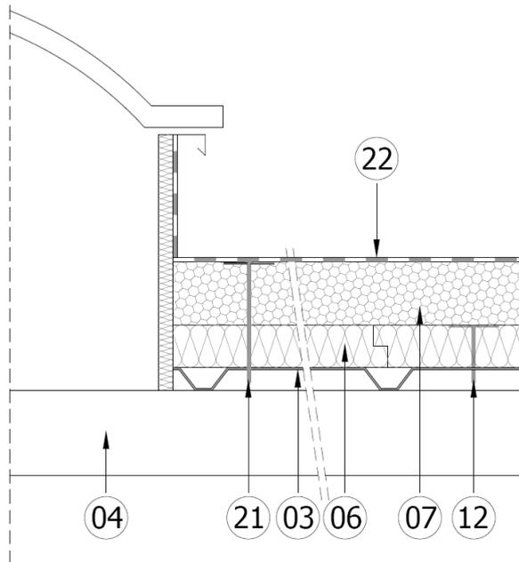
Le lit supérieur en panneau KNAUF Therm TTI Se (07) est en contact avec la costière pré-isolée.
