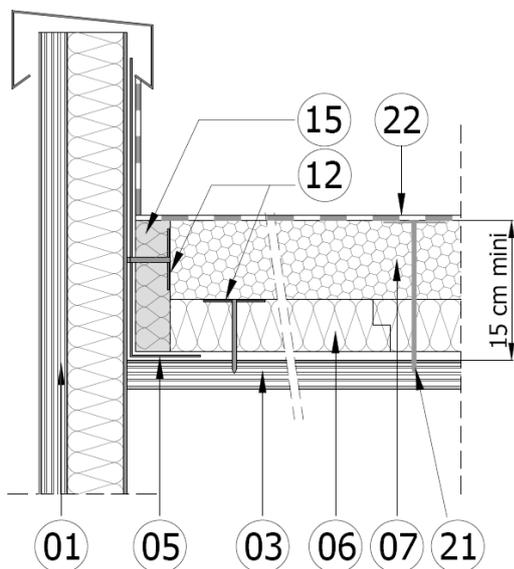
Le calfeutrement est réalisé par un panneau vertical de laine de roche (15), découpé sur une hauteur minimale de 15 cm et égale à l'épaisseur totale de l'écran thermique (06) plus celle du panneau KNAUF Therm TTI Se (07) ; il est fixé mécaniquement dans l'aile verticale de la costière métallique (05) à raison d'une fixation (12) par panneau.
