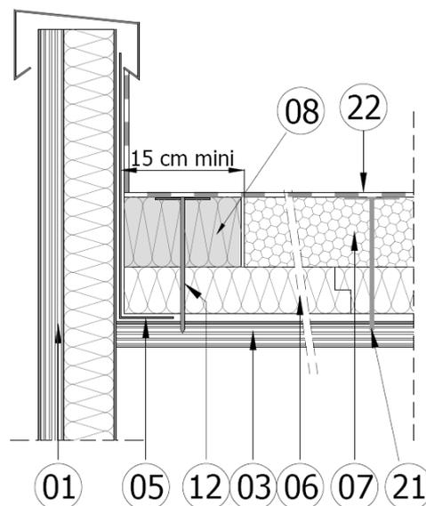
Le calfeutrement est réalisé par un panneau de laine de roche (08), d'épaisseur égale à celle du lit supérieur en panneau KNAUF Therm TTI Se (7) et découpé sur une largeur minimale de 15 cm ; il est fixé mécaniquement à l'élément porteur (05) à raison d'une fixation (12) par panneau.
