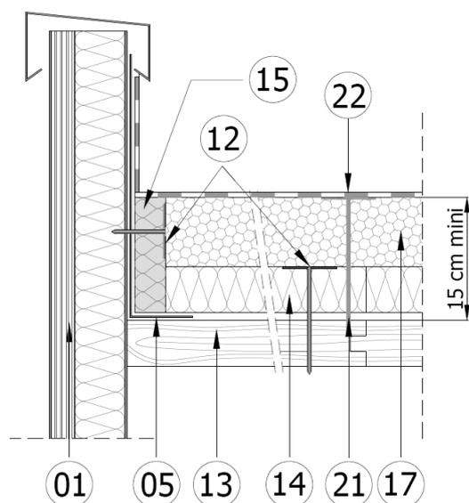
Le calfeutrement est réalisé par un panneau vertical laine de roche (15), découpé sur une hauteur minimale de 15 cm et égale à l'épaisseur totale de l'écran thermique (14) plus celle du panneau KNAUF Therm TTI Se (17) ; il est fixé mécaniquement dans l'aile verticale de la costière métallique (05) à raison d'une fixation (12) par panneau.
