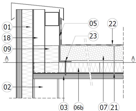
L'espace situé entre la costière métallique et la paroi verticale est comblé par le panneau de laine de roche de classe C (06b) prolongé jusqu'à l'extrémité de l'élément porteur (03).
