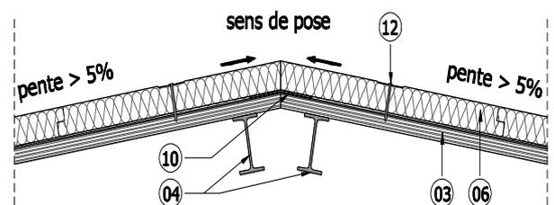
**Figure 3d – Raccordement des panneaux DDP RT LJ en faitage et arêtier - appuis doubles**
