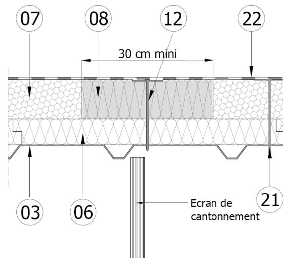
Le recouvrement est réalisé par un panneau laine de roche (08) d'épaisseur égale à celle du lit supérieur en panneau KNAUF Therm TTI Se (07) et découpé sur une largeur minimale de 30 cm ; il est fixé mécaniquement dans l'élément porteur (03) à raison d'une fixation (12) par panneau.
