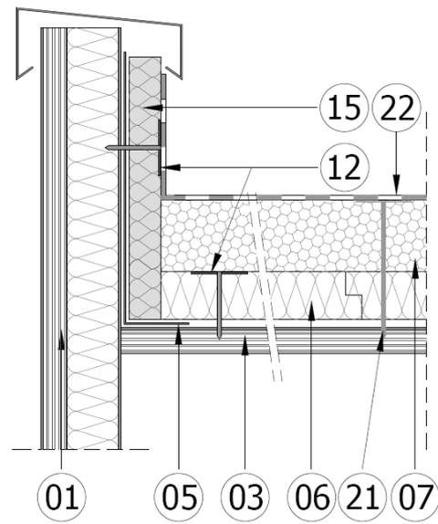
Le panneau vertical de laine de roche (15), est fixé mécaniquement (12) dans l'aile verticale de la costière métallique (05).
