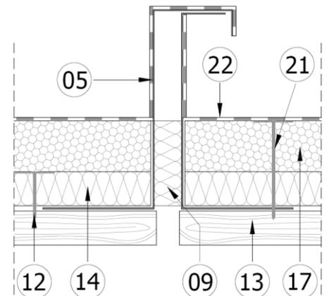
L'espace situé entre les deux costières métalliques est comblé par un isolant compressible (09) de classe A2, s2-d0 au moins. L'aile horizontale de chaque costière métallique (05) est fixée dans l'élément porteur (13) conformément au NF DTU 43.4 P1.
