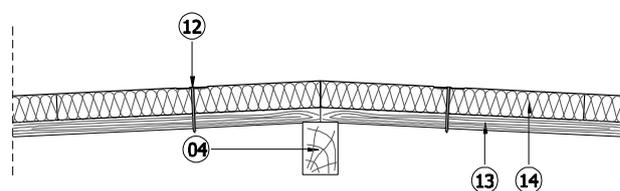
Le joint filant entre les panneaux DDP RT (14) est situé au droit d'un élément d'ossature principal ou secondaire (04)
