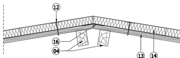
Une bande métallique (16) est placée et fixée au-dessus de l'élément porteur, sous le pare-vapeur, la mise en œuvre de cette bande métallique (quelque soit la largeur du joint du joint des éléments métalliques au faite ou en noue) est obligatoire sur deux appuis.
