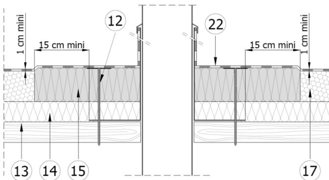
Le calfeutrement autour d'un conduit ou gaine métallique traversant la toiture est réalisé par un panneau laine de roche (15) d'épaisseur supérieure d'au moins 1 cm à celle du lit supérieur en panneau KNAUF Therm TTI Se (17) et découpé sur une largeur dépassant de 15 cm au moins le bord de l'aile horizontale de la costière métallique (05) ; il est placé au-dessus de l'écran thermique (14) et est fixé mécaniquement (12) dans l'élément porteur (13).
