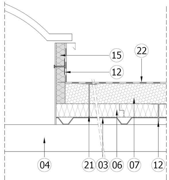
Le panneau vertical de laine de roche (15), ou en perlite expansée (fibrée), de résistance thermique déclarée minimale conforme à sa norme produit, est fixé mécaniquement (12) (§ 2.273b) dans la costière métallique ou lanterneau ou exutoire.
