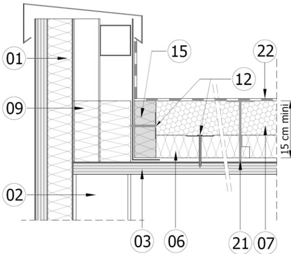
L'espace situé entre la costière métallique et la paroi verticale est comblé par un isolant (09) de classe A2, s2-d0 au moins, d'épaisseur minimale 60 mm.
