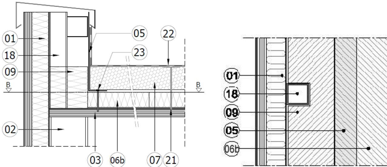
L'espace situé entre la costière métallique et la paroi verticale est comblé jusqu'au niveau supérieur du panneau KNAUF Therm TTI Se (07) par un isolant (09) de classe minimale A2-s2,d0.
