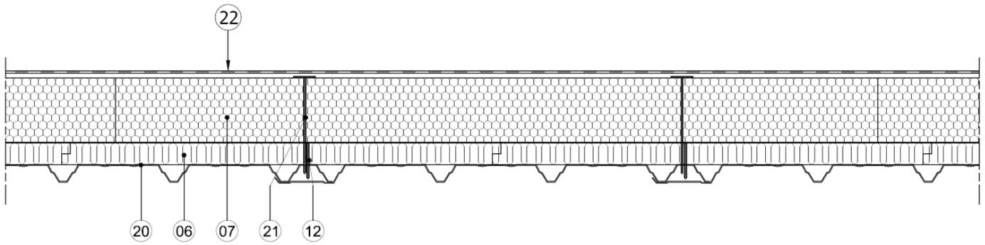
Chaque panneau DDP RT LJ est fixé (12) dans chaque « nervure caisson » de la tôle d'acier nervurée (20). Chaque panneau KNAUF Therm TTI Se (07) de format spécifique 1 770 × 1 200 mm est fixé (21) dans chaque « nervure caisson » de la tôle d'acier nervurée (20).
