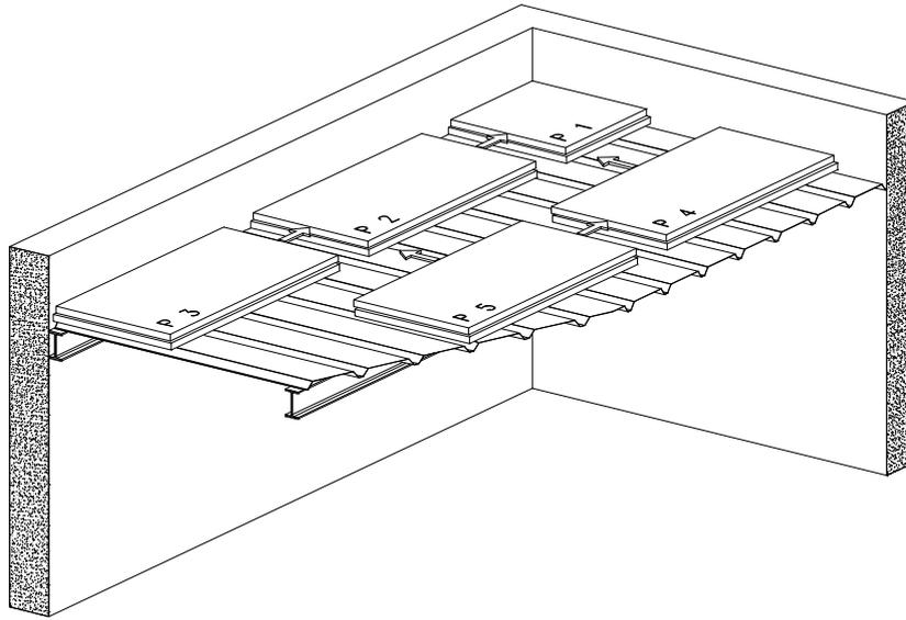
Les feuillures du 1<sup>er</sup> lit en panneaux DDP RT LJ sont découpées en angle, sur 2 côtés (P1) et en rives, sur un côté (P2, P3 et P4)
