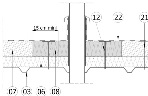
Le calfeutrement autour du fourreau de conduit ou gaine métallique traversant la toiture est réalisé par un panneau de laine de roche (08) d'épaisseur égale à celle du lit supérieur en panneau KNAUF Therm TTI Se (07) et découpé sur une largeur dépassant de 15 cm au moins le bord de la platine ; il est placé au-dessus de l'écran thermique (06) et est fixé mécaniquement (12) dans l'élément porteur (03).
