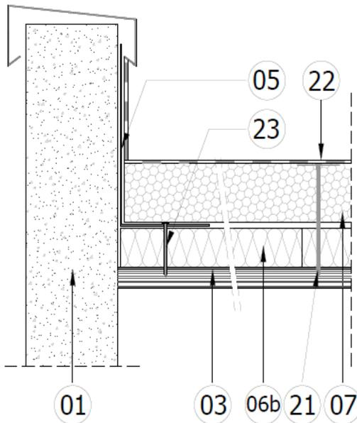
L'aile horizontale de la costière métallique (05) est placée au-dessus du panneau de laine de roche classe C (06b) formant écran thermique ; elle est fixée dans l'élément porteur (03) selon le NF DTU 43.3 P1.
