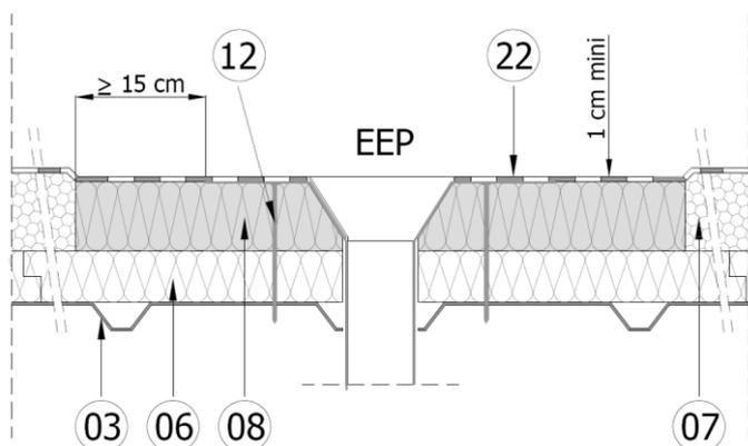
Le calfeutrement autour de l'entrée d'eau pluviale est réalisé par un panneau de laine de roche (08) d'épaisseur inférieure d'au moins 1 cm à celle du lit supérieur en panneau KNAUF Therm TTI Se (07) et découpé sur une largeur dépassant de 15 cm au moins le bord de la platine d'entrée d'eau pluviale ; il est placé au-dessus de l'écran thermique (06) et est fixé mécaniquement (12) dans l'élément porteur (03).
