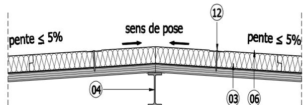
**Figure 3b – Raccordement des panneaux DDP RT LJ en faitage et arêtier - appui simple**
