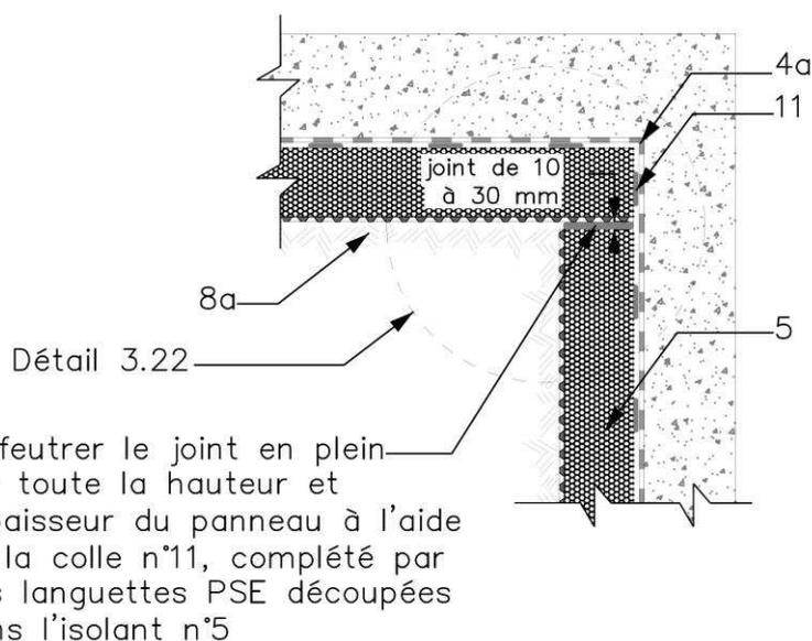
Calfeutrer le joint en plein sur toute la hauteur et l'épaisseur du panneau à l'aide de la colle n°11, complété par des languettes PSE découpées dans l'isolant n°5
