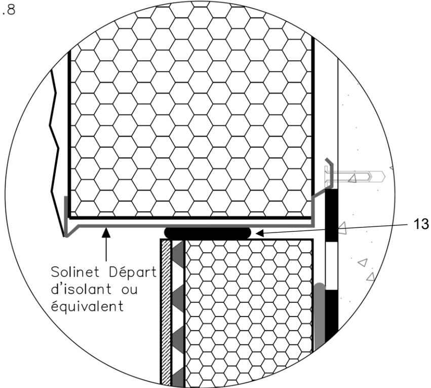
Figure 1C: Exemple de saut de loup sur mur enterré isolé de Catégorie 1
