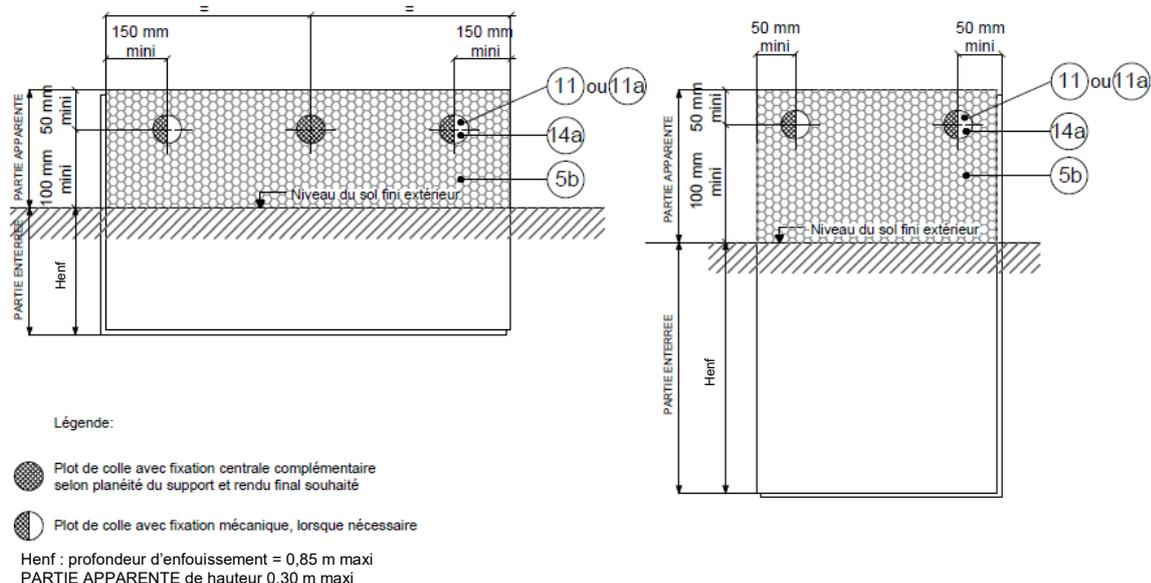
**Schéma 4 : exemple de position des plots de colle et des fixations sur mur enterré isolé de catégorie 1 avec revêtement d'étanchéité ou imperméabilisation et K Périgoard Ultra+ – vue arrière du panneau en pose horizontale et verticale**
