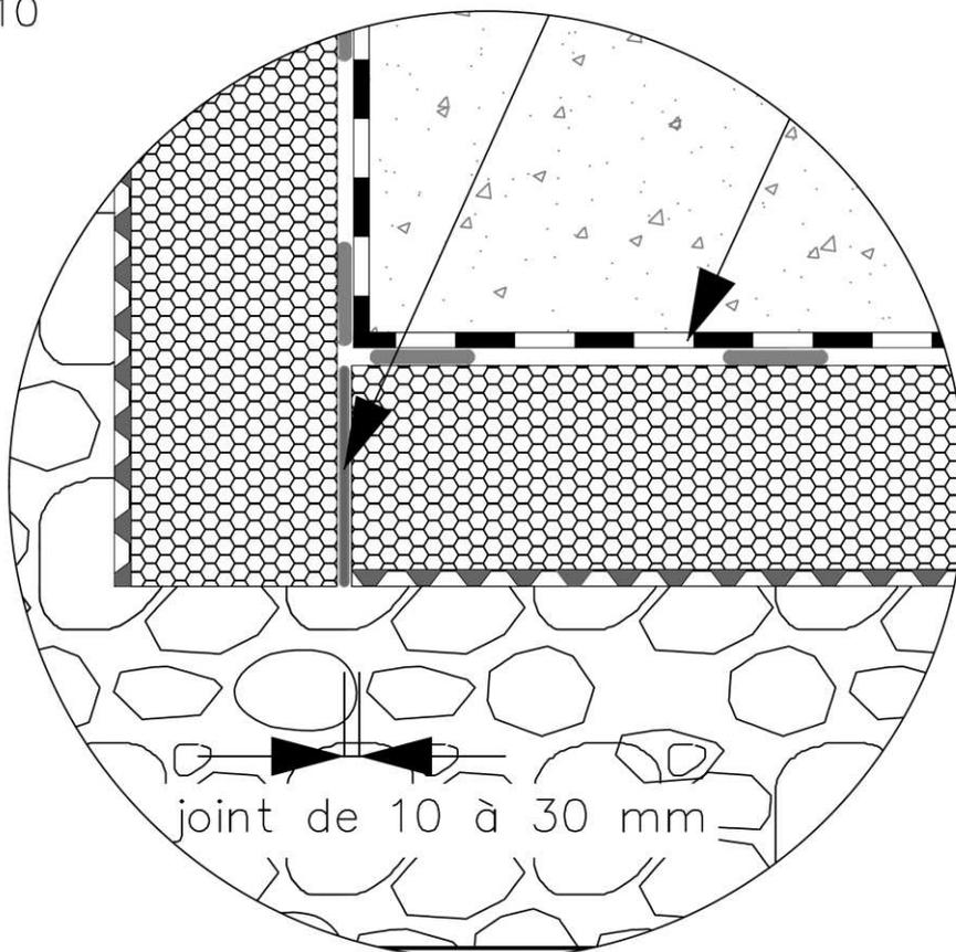
Figure 1F: Angle rentrant sur mur enterré isolé de Catégorie 1, si joint de largeur inférieure ou égale à 10 mm (coupe horizontale sur partie enterrée)
