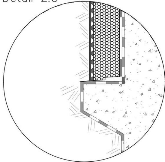
Figure 2C: Exemple de mur enterré isolé sur une rangée de panneaux, Catégorie 2 avec plaque
