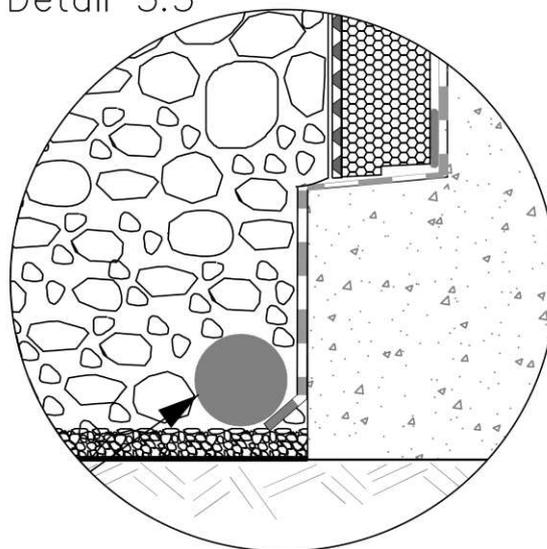
Figure 3C: Exemple de longrine enterrée isolée de Catégorie 3 avec caniveau
