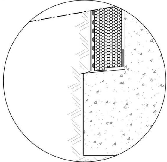
Figure 3G: Angle sortant sur mur enterré isolé de Cat. 3 avec imper., si joint de largeur inf. ou égale à 10 mm (coupe horizontale sur partie enterrée)
