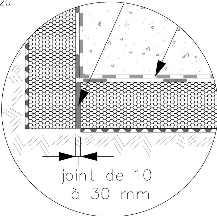
Figure 3I: Angle sortant sur mur enterré isolé de Catégorie 3 (coupe horizontale sur partie enterrée)
