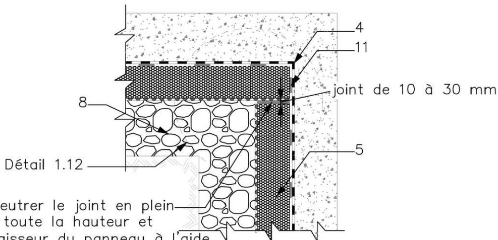
Calfeutrer le joint en plein sur toute la hauteur et l'épaisseur du panneau à l'aide de la colle n°11, complété par des languettes PSE découpées dans l'isolant n°5
