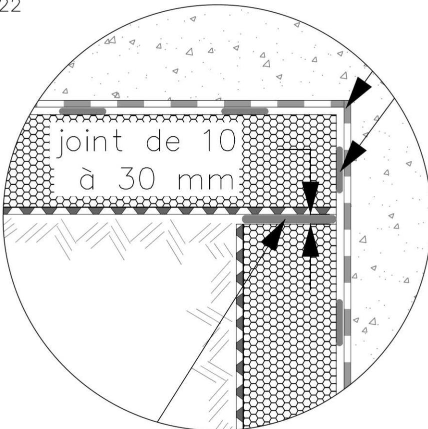
Figure 3M : Exemple de longrine enterrée isolée de Catégorie 3 avec mur brut, K Perimaxx et K Périboard Ultra+
