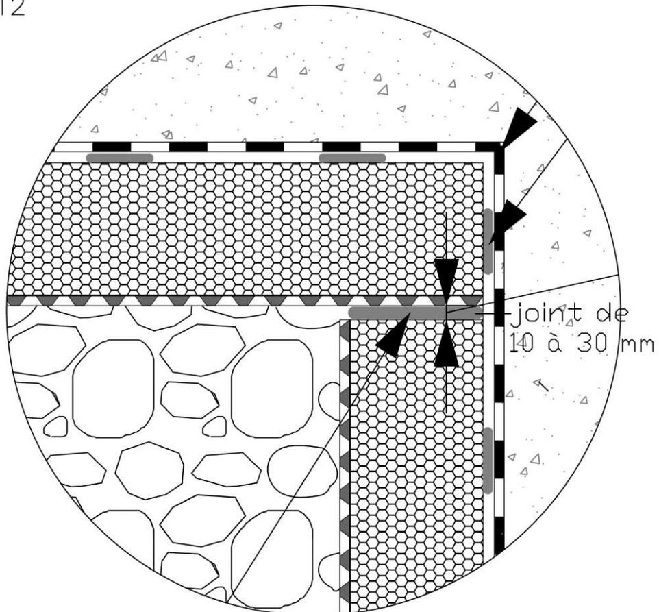
Figure 1H: Joint de dilatation sur mur de Catégorie 1
