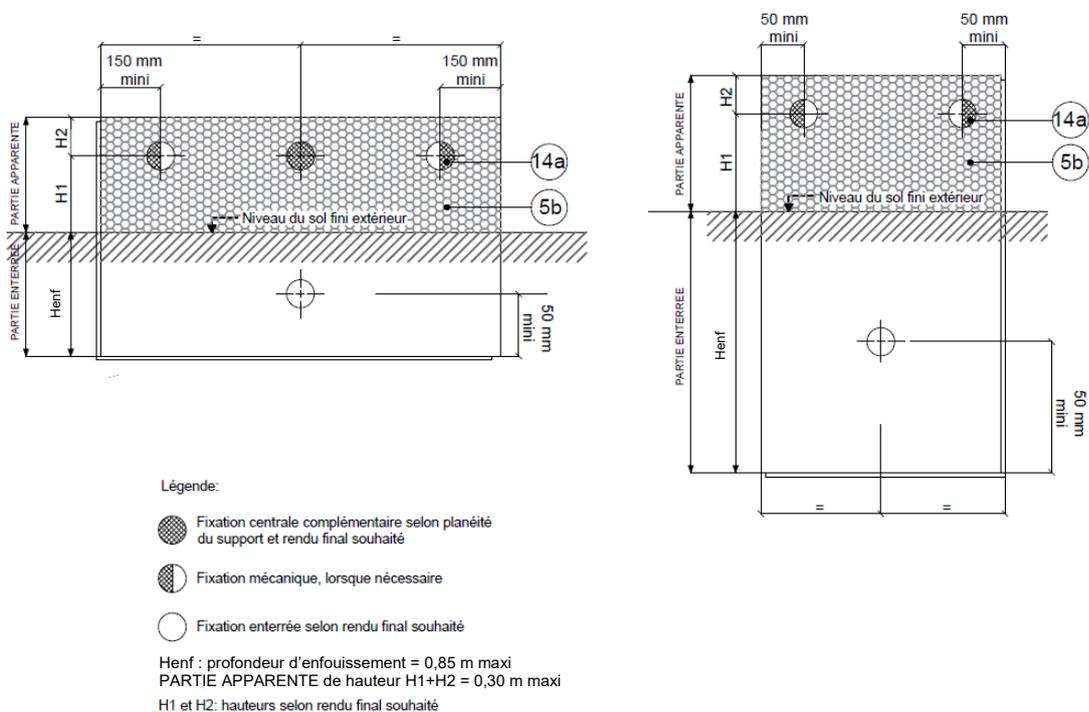
**Schéma 5 : exemple de position des plots de colle et des fixations sur mur enterré isolé de catégorie 2 sans imperméabilisation ou catégorie 3 et K Périgoard Ultra+ – vue arrière du panneau en pose horizontale et verticale**
