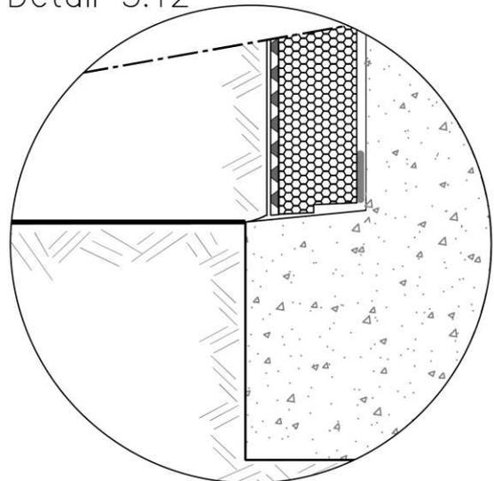
Figure 3E: Exemple de longrine enterrée isolée de Cat. 3 avec profilé
