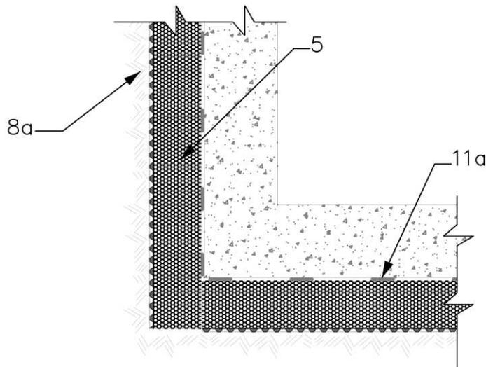
Figure 3J: Angle rentrant sur mur enterré isolé de Catégorie 3 (coupe horizontale sur partie enterrée)
