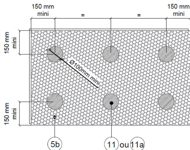
**Schéma 3 : exemple de position des plots de colle – vue arrière du panneau K Périboard Ultra+**
