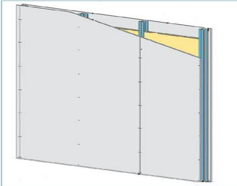
Cloison distributive sur ossature métallique
